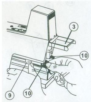
Степлер снабжен двусторонним регулятором глубины степлирования. Каждый регулятор может использоваться независимо.
