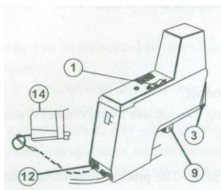
1. Выключите сетевой выключатель (1) или поднимите защитный экран (3)
